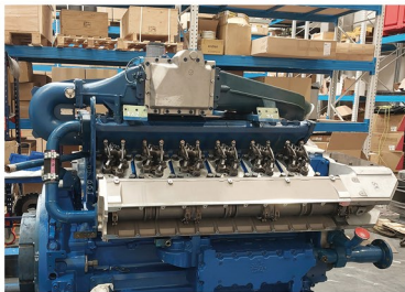
ODBUDOWA SILNIKA MWM TCG2016V12 NA BAZIE LONG BLOCK I NOWYCH ELEMENTÓW UKŁADU WYDECHOWEGO, CHŁODZENIA I CHŁODZENIA MIESZANKI.
